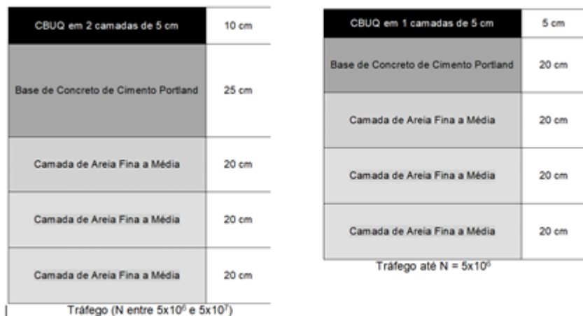
Figura 3. Seção Típica reposição do asfalto em CBUQ - Corte Esquemático
